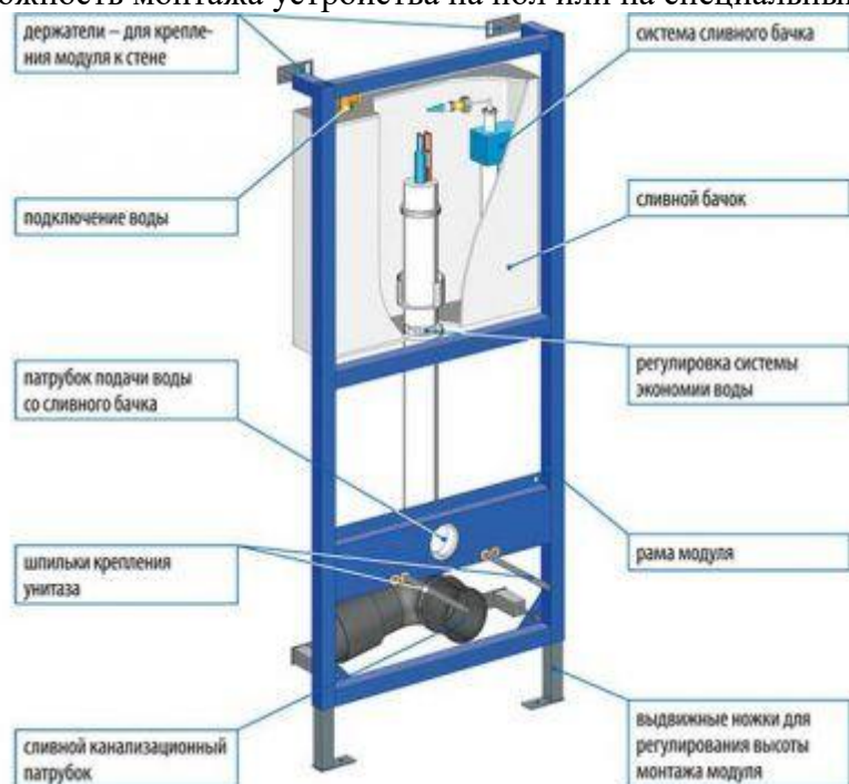
Рис.2. В комплект также входят необходимые фрагменты крепления, элементы шумоизоляции, переходник для смывного колена и бачок скрытой установки.
